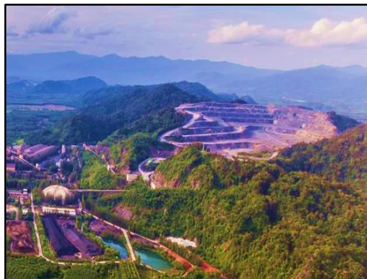
ภาพที่ 1.3 สภาพการทำเหมืองหินปูน ด้วยวิธีเหมืองหาบ แบบขั้นบันได (Open Cut) ในปัจจุบัน
